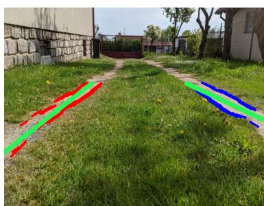
(b) : Aplikace Houghovy transformace s polynomickou regresí
